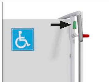
Rampe inférieure déverrouillée en position fermée
