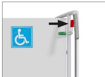
Rampa inferiore bloccata in posizione chiusa.
