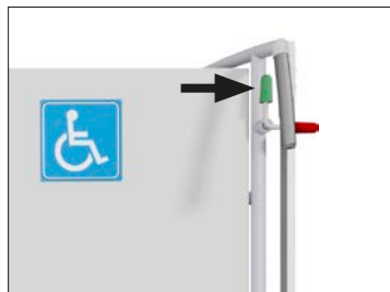
Rampa inferiore sbloccata in posizione chiusa.
