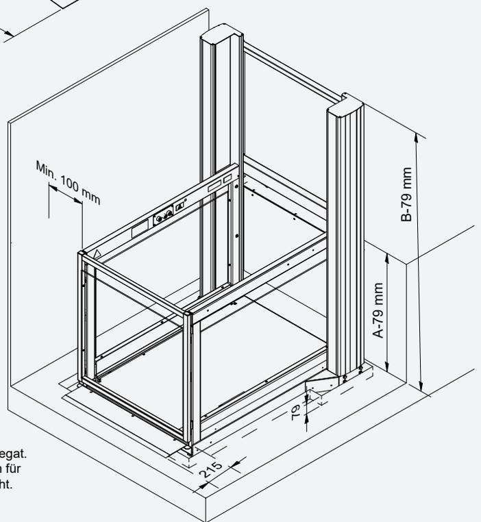
**✘** Die Elektro- / Hydraulikeinheit kann in einem Radius von ca. 2,5 m um den Punkt X platziert werden. Der Stromanschluss muss da platziert werden, wo auch die Hydraulikeinheit installiert werden soll.
