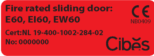
Fig. 53 Typeskilt for brandklassificeret elevatorstoldør
