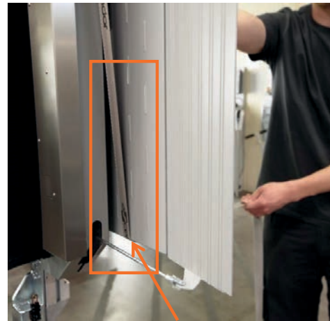
Sæt spændestroppen nederst mellem platformen og gevindstangen.
