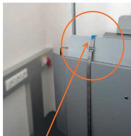
Hvis rampen er foran, skal du føre spændestroppen over rampens overkant.
