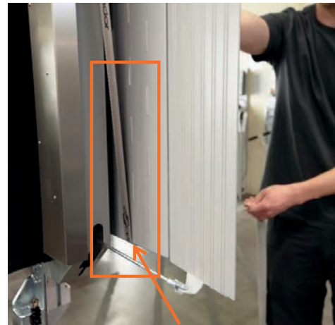
Sæt spændestroppen nederst mellem platformen og gevindstangen.
