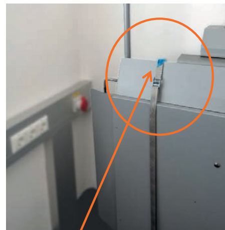
Hvis rampen er foran, skal du føre spændestroppen over rampens overkant.
