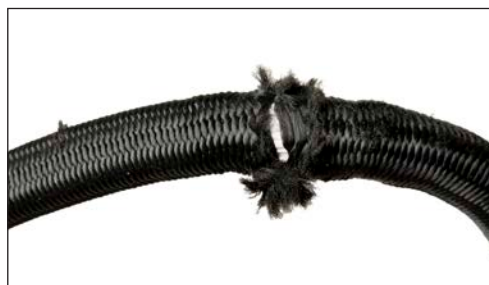
Eksempel på en defekt line
