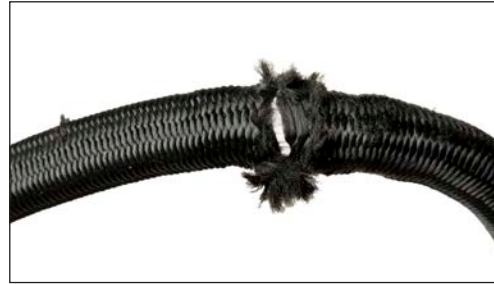
Ejemplo de una línea defectuosa
