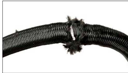
Beispiel eines defekten Seils
