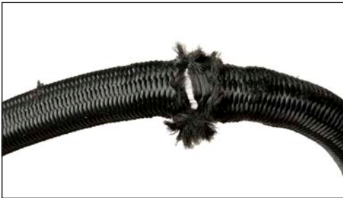
Voorbeeld van een defecte lijn
