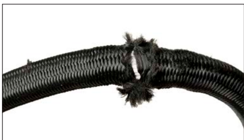
Exempel på en defekt lina
