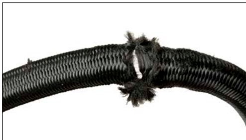
Exemple d'une ligne défectueuse
